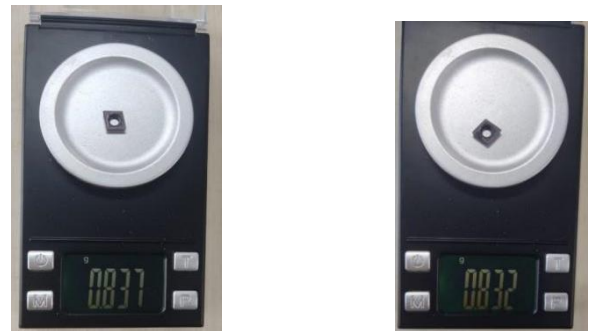
Gambar 3. Pengukuran Massa Pahat Sebelum dan Setelah Pembubutan
